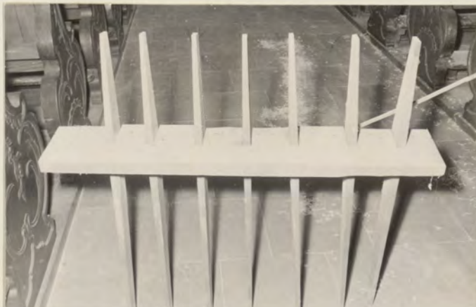
E 33 HW Schlüssel der Registertraktur, oben Eingriff in die Schleifen
