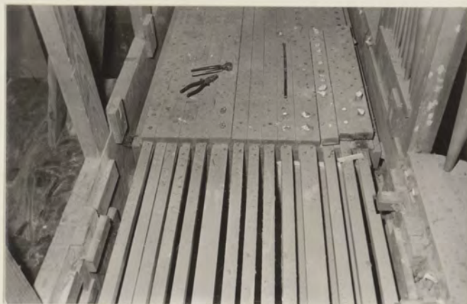
E 19 HW Cs-Seite mit Stöcken und Verbindungsstangen zu den Schleifen der C-Lade
